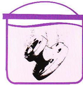
Impregnación de las piezas en un autoclave. Se sumergen las piezas en el producto impregnante, efectuando un elevado vacío de 3-5 mb, con objeto de que penetre el producto en las porosidades.
